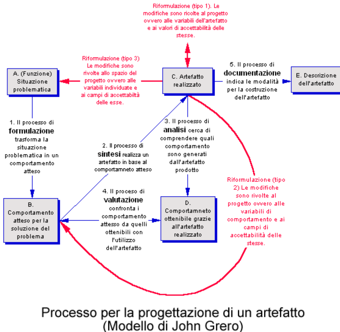
La Figura 2 - Modello per la progettazione di un artefatto di J. Gero
